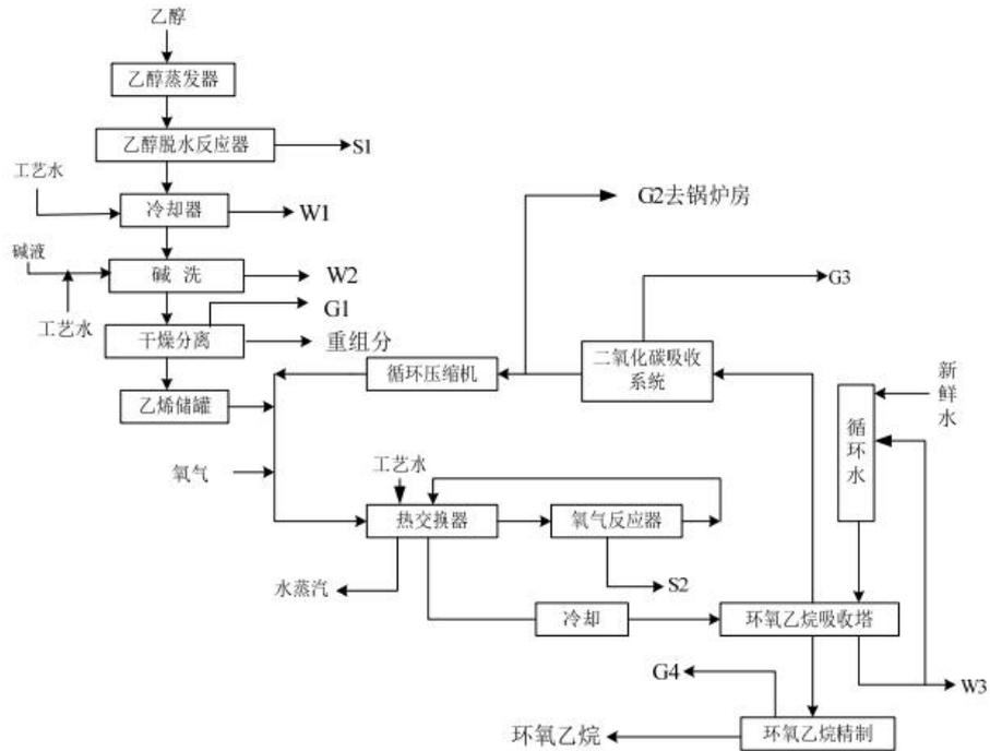
图 7 环氧乙烷生产工艺及产排污环节图
