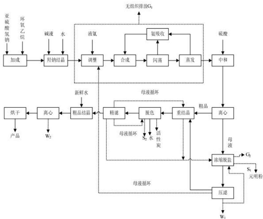
图 6 牛磺酸生产工艺及产排污节点图
