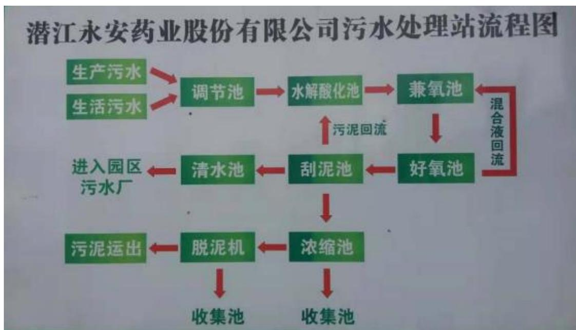
工艺流程说明：厂内生产废水和生活污水先进入调节池，因车间排出的废水水质、水量、水温、pH值差异而导致冲击负荷给后续处理造成影响，故采用调节池调节。进入水解酸化池后由于水解酸化池中有污泥床，污泥床上含有高浓度的兼性微生物膜，经水解酸化后的污水进入兼氧池，在兼氧池中分上层好氧和下层厌氧同时作用，加强对污水中有机物的降解。废水经好氧生物处理后，其中一部分有机物被氧化分解成无机物，另一部分被合成细菌细胞，细菌颗粒较大，具有良好的凝聚性能，可以凝聚成更大的絮状物，并在沉淀池中沉淀去除，沉淀下来的生物污泥进入污泥浓缩池。清水经管廊排入园区工业污水处理厂深度处理后外排。
